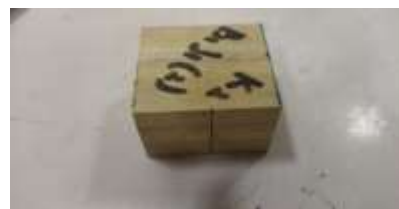
Gambar 1. Contoh uji kadar air dan kerapatan
